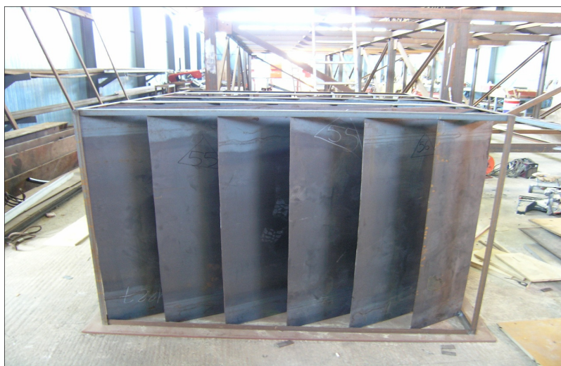
Κυψέλες απορρόφησης με πτερύγια κατά τη φάση της κατασκευής
